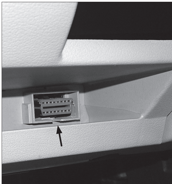
Diagnostická zásuvka je umístěna pod spodní hranou palubní desky pod volantovou tyčí. Najdete ji lehce, protože je barevně odlišena od barvy čalounění.
