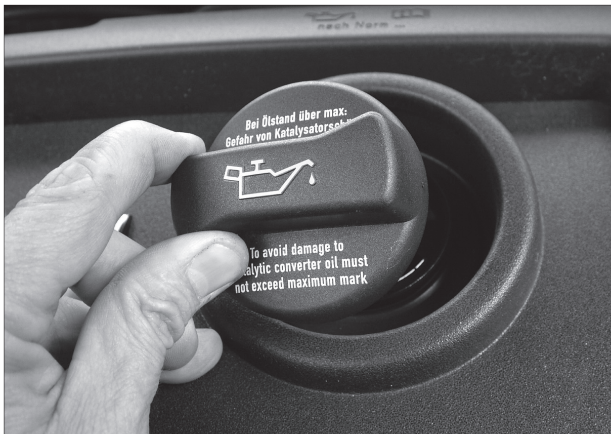
Zátka otvoru pro doplňování motorového oleje je označena symbolem mazání, stejným symbolem, jaký se nachází ve formě kontrolního světla na přístrojovém panelu. Zátku najdete na všech typech motorů nahoře na víku motoru.
