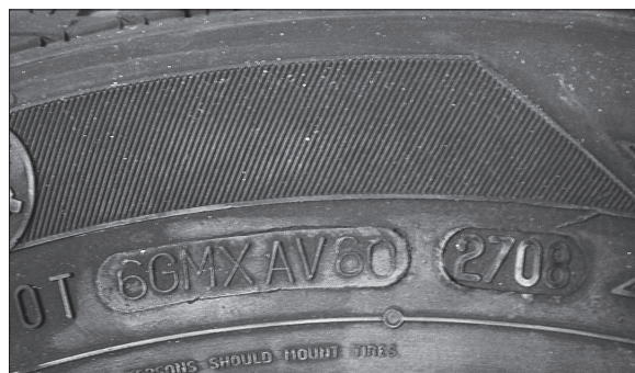
Na bočnici pneumatiky najdete mimo jiné i datum výroby DOT 2708 – 27. týden roku 2008.
