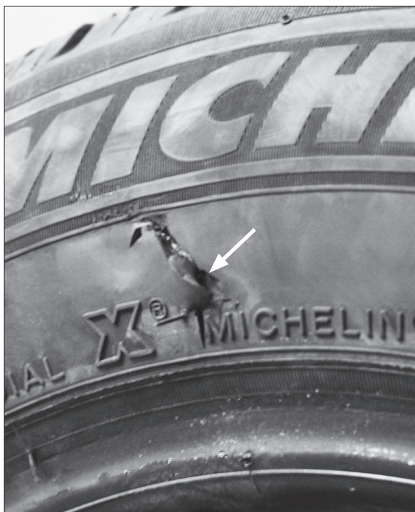
Bočnice pneumatiky poškozená od prudkého najetí na obrubník chodníku. Poškození je neopravitelné a je nutné pneumatiku vyměnit.
