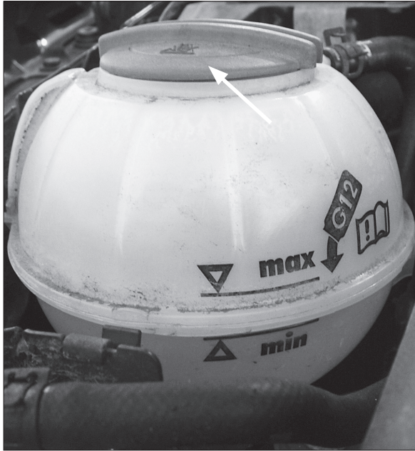
Zásobní nádobka chladicí kapaliny s modrým šroubovacím uzávěrem – viz šipka. Hladina kapaliny se musí pohybovat mezi ryskami MIN a MAX. Nádobka chladicí kapaliny je na stejném místě u všech modelových řad Octavie.
