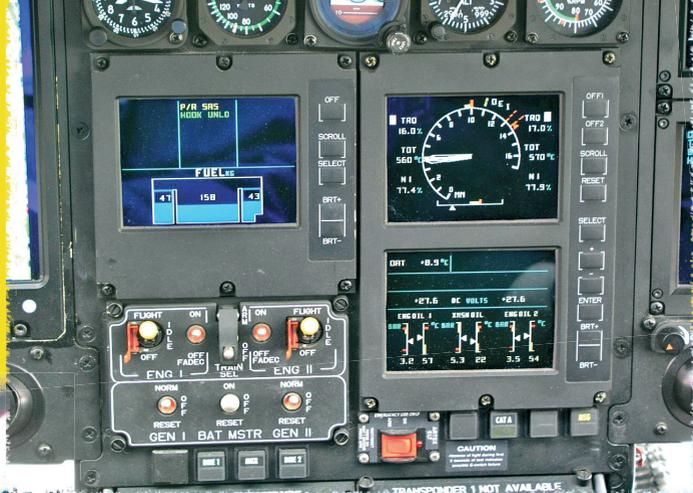
Tzv. „Glass cockpit“ EC-135 se šesticí sdružených displejů je nadstandardní vybavení tohoto typu vrtulníku. Jedná se o digitální zobrazení letových a navigačních přístrojů (včetně zobrazení pohyblivé mapy nebo obrazu z termovize (FLIR), včetně přístrojů pro kontrolu chodu pohonné jednotky a drakových systémů). Zároveň je toto digitální zobrazení plně kompatibilní s přístroji pro noční vidění (Night Vision Goggles), dnes již standardně používanými LS PČR pro noční lety. (A. Truhlář, duben 2004)
