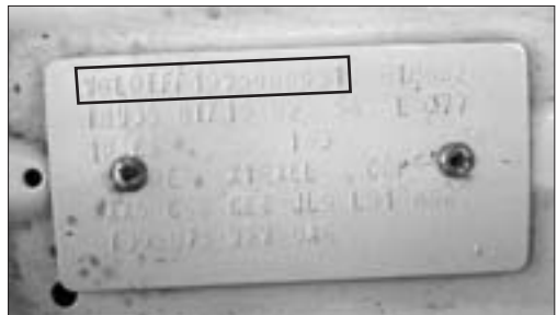
Detail VIN kódu na výrobním štítku na horní straně chladičové stěny. Štítek je připevněn nýtováním. Jednotlivá písmena a číslice na štítku musí být zřetelné, pravidelně umístěné, stejné výšky a stylu.
