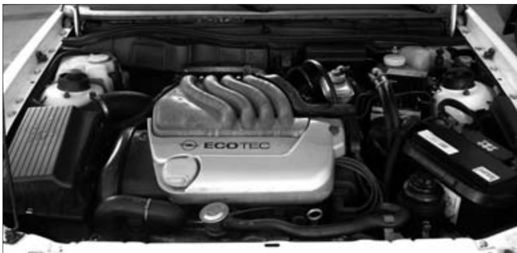
Zážehový motor o objemu 1,6 litru s výkonem 74 kW montovaný do Astry F (na obrázku) a později do Astry G. Kód motoru X16XEL. Rozvodový mechanismus je poháněn řemenem.
