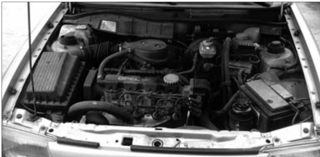
Spolehlivá a jednoduchá osmiventilová šestnáctistovka je nenáročná na údržbu. Zážehový motor (C16NZ) montovaný do Astry F měl výkon 55 kW.
