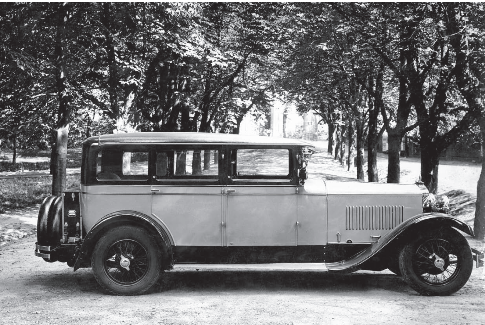
V. Brožík a synové, Plzeň – Luxusní šestisedadlová karoserie na podvozku Škoda 6R – 20. léta 20. století
