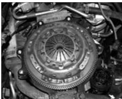
Přítlačný talíř zakrývá třecí kotouč (lamelu spojky). Na snímku je demontována převodovka.
