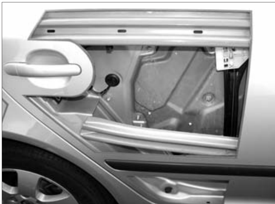
Všechny modely Fabie II mají ve dveřích bezpečnostní ocelovou výztuhu proti bočnímu nárazu.
