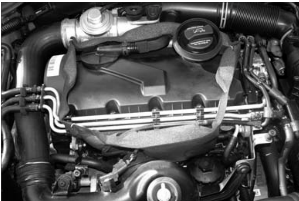
Vznětový motor 1,9 TDI PD (kód motoru BSW) o výkonu 77 kW bez horního plastového krytu.
