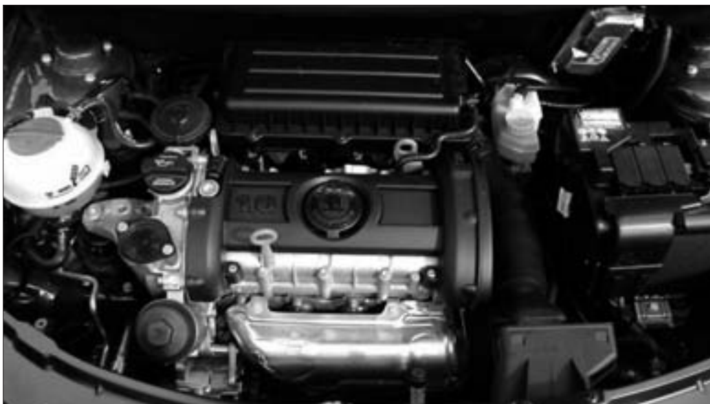
Pohled na zážehový motor 1,6 16V (kód motoru BTS) o výkonu 77 kW.
