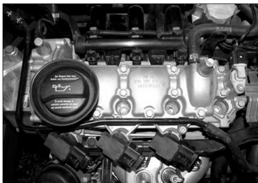
V motorovém prostoru (motor 1.2) kontrolujte upevnění hadic, kabelů a potrubí.
