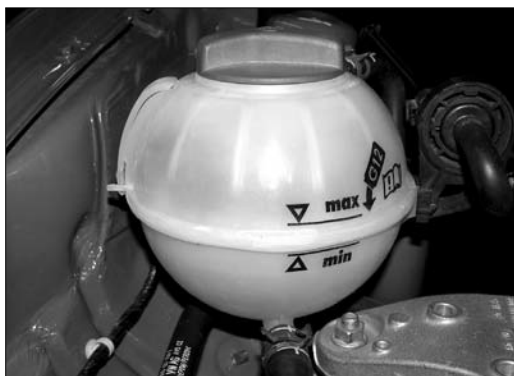
V nádobce chladicí kapaliny musí být hladina mezi ryskami MIN a MAX.
