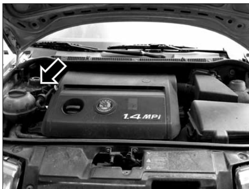
Kontrola hladiny chladicí směsi (šipka) v expanzní nádobce je z hlediska spolehlivosti motoru prioritní.
