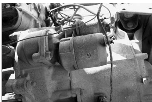
Zkontrolujte slabší kabel, který je připojen pomocí zasouvacího konektoru, i silnější kabel, který je na svorník startéru upevněn maticí
