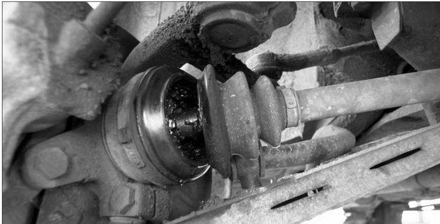
Poškozená manžeta homokinetického kloubu přední nápravy. Závada, se kterou můžete pokračovat v jízdě, ale co nejdříve manžetu nechte vyměnit za novou, jinak dojde k poškození kloubu, případně jeho zatuhnutí vlivem nedostatku mazacího tuku.
