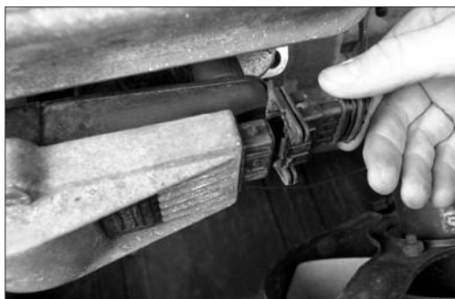
Zapalovací cívka je u motorů 1,3 MPi připojena přímo na zapalovací svíčky. Odpadají tak možné závady s vysokonapěťovými kabely jednotlivých svíček
