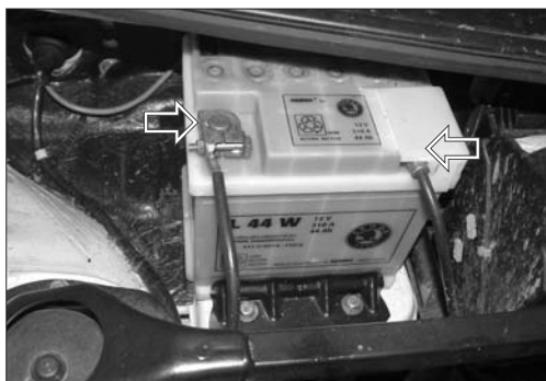
Klíčem číslo deset (nebo alespoň pohybem ruky) zkontrolujte utažení obou svorek na akumulátoru
