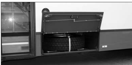
Umístění rezervního kola v boční schránce autobusu
