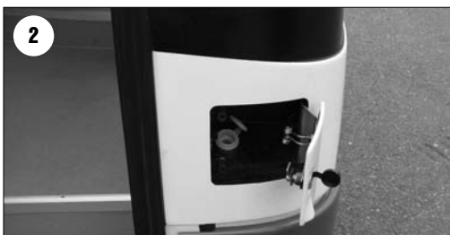
Umístění nádržek na provozní kapaliny: 1 – nádržka chladicí kapaliny, 2 – nádržka ostříkovače
