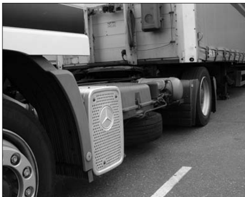
Najíždění tahače pod návěs a sprážení soupravy
