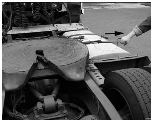
Odjištění čelistového mechanismu
