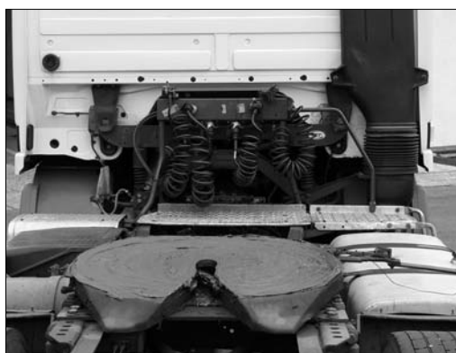
Umístění spojovacích prvků vzduchotlakové a elektrické soustavy na tahači
