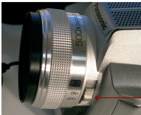
Obrázek 4.22 Poloha ON zapne automatické zaostřování, poloha OFF jej vypne
