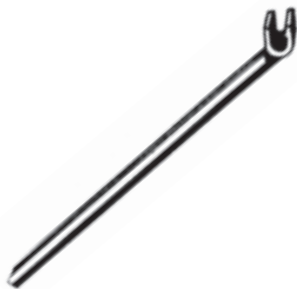
Obr. 60: Páka S-89 pro seřízení aretace řadicí kulisy
