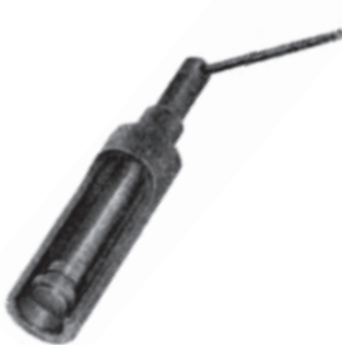
Obr. 52: Stahovák S-9 na vodící pouzdra přední vidlice
