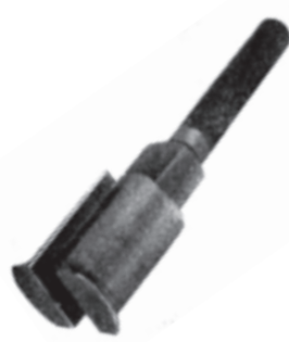
Obr. 53: Vytlačovák vnitřního ložiska levé poloviny skříně
