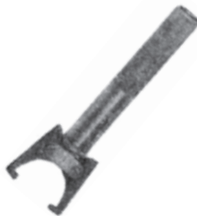
Obr. 55: Klíč na těsnicí matici přední vidlice
