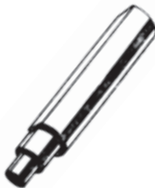
Obr. 58: Vylisovací kolík pístního čepu S-87
