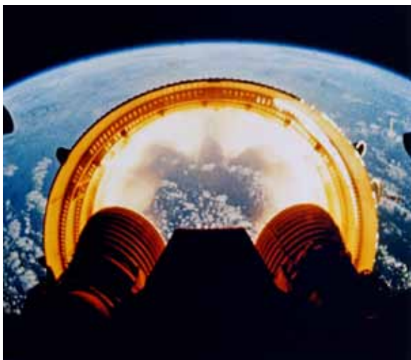
Odhození pomocné konstrukce mezi prvním a druhým stupněm. Často jsou tyto záběry označovány jako „Apollo 11“, ale vznikly právě při startu druhého Saturnu V s lodí Apollo 6 (natáčené byly na filmový pás a následně přistávaly do oceánu v malých modulech)
