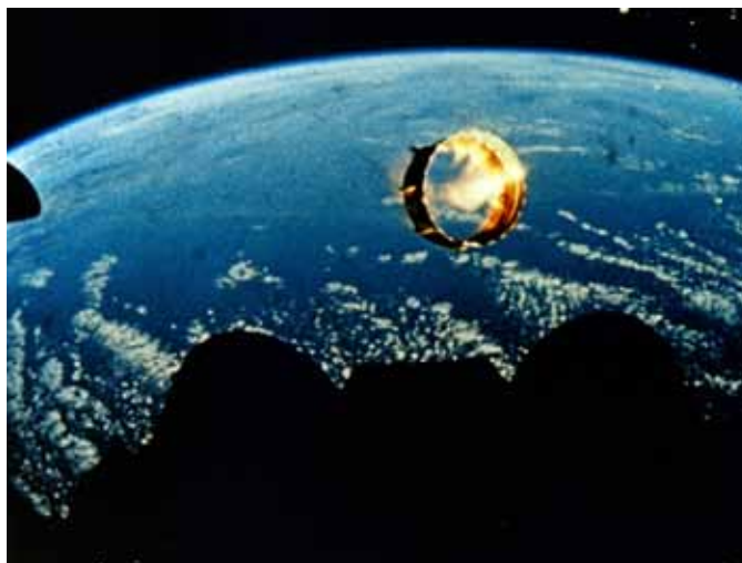
Odhození pomocné konstrukce mezi prvním a druhým stupněm. Často jsou tyto záběry označovány jako „Apollo 11“, ale vznikly právě při startu druhého Saturnu V s lodí Apollo 6 (natáčené byly na filmový pás a následně přistávaly do oceánu v malých modulech)
