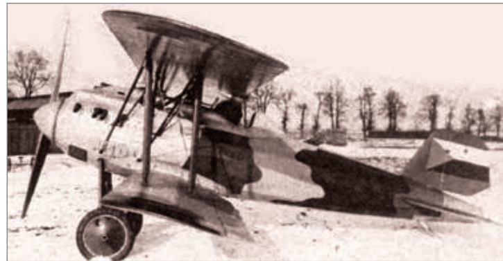
↑ Letov Š-7 z roku 1923 byl poháněn motorem Hispano-Suiza F8b o výkonu 220 kW (300 k).
