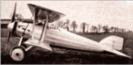
↑ Letov Š-4 s původním provedením kruhového chladiče
