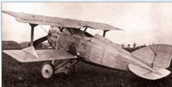
← Původní provedení Aera Ae-04 s čelním chladičem
