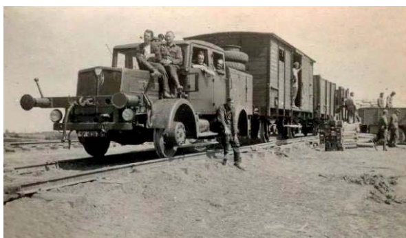
Pro dopravu na frontě využívala německá armáda nákladní auta se železničními koly – zdroj: https://cs.wikipedia
