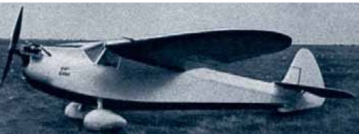
V roce 1937 byl do draku Pragy E-114 zabudován nový plochý čtyřválec Praga D o výkonu 79 k (59 kW). Výkonnější letoun dostal nové označení Praga E-115.
