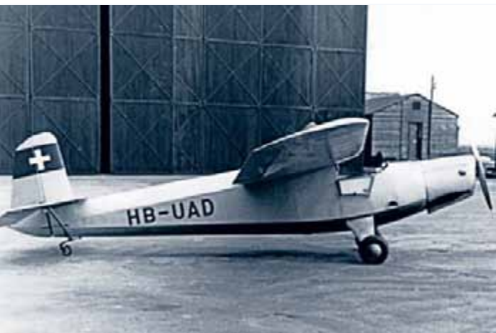
Praga E-114 v. č. 122 z poloviny padesátých let s motorem Walter Mikron
