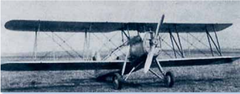
Prvním letounem vyvinutým v ČKD Praga pro potřeby vojenského letectva byl cvičný typ Praga BH-41, později přeznačená na Praga E-41.
