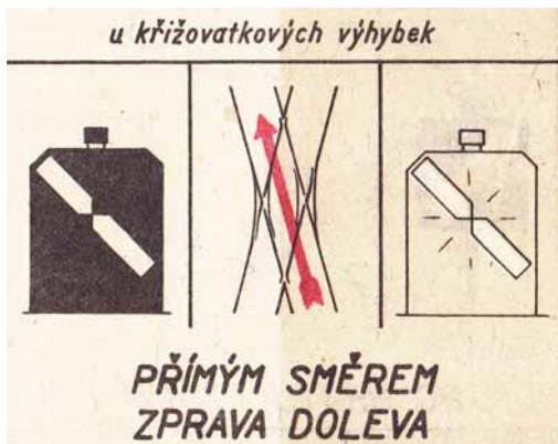
▲ Obr. 37 Návěstní těleso křižovatkové výhybky – přímým směrem zprava doleva
