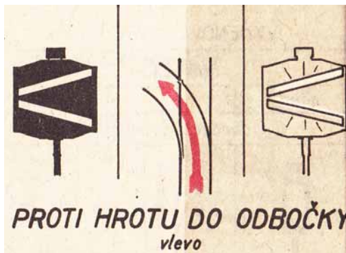
▲ Obr. 35 Návěstní těleso výhybky – proti hrotu do odbočky vlevo
