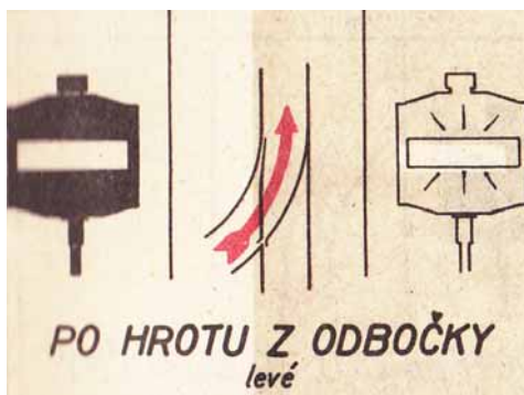
▲ Obr. 36 Návěstní těleso výhybky – po hrotu z odbočky levé
