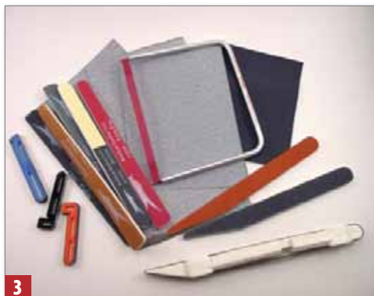
3 Modeláři používají brusné papíry o různé zrnitosti, speciální brousítka a brusné pěnové hranoly, které se vyrábějí s povrchy od velmi drsných až k extra jemným.
