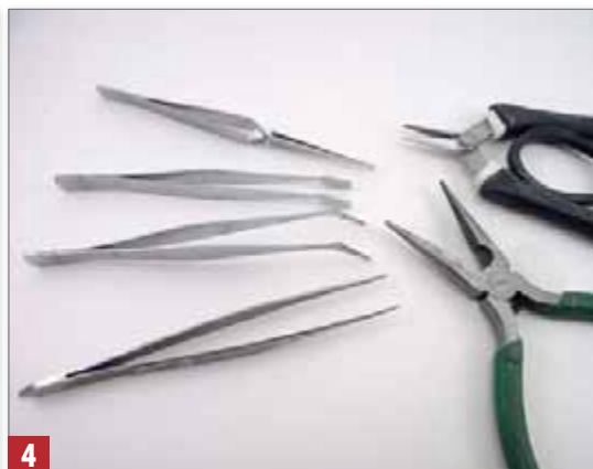
4 Pro manipulaci s díly budete potřebovat (ve směru hodinových ručiček zleva odspodu) dlouhou špičatou pinzetu, zahnutou pinzetu, pinzetu s plochými hroty a stiskací pinzetu. Také se vám budou hodit kleštěčky s rovnými hladkými čelistmi a kleštěčky s kuželovými čelistmi (vpravo).
