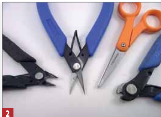
2 Štípací a řezací nástroje, které modelář potřebuje, jsou zleva kleštěčky na vtoky, nůžky na oddělování leptaných dílů z mosazi nebo oceli, nůžky na vystřihování obtisků a stranové štípací kleště.
