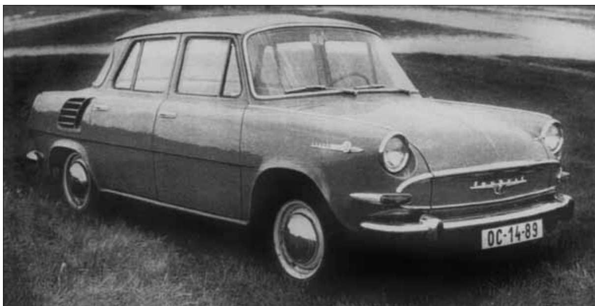
Na jaře roku 1962 byla u některých předsériových vozů upravena před' posunutím uložení světlometů směrem dozadu a montáží jinak tvarovaných nárazníků i okrasných lišt do podoby, jen málo se lišící od sériových vozů.
