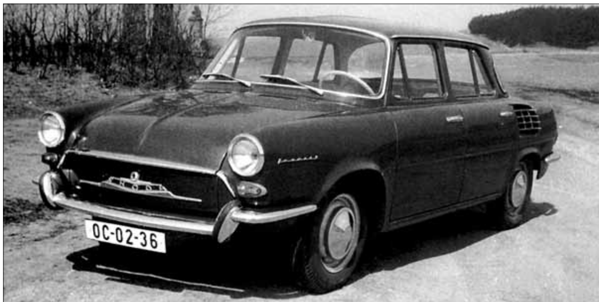
Škoda typ 990 NOV z padesátikusové předsérie z roku 1961 se kromě nápisu Favorit na předním blatníku, vyčnívajících světlometů a lomených nárazníků lišil od budoucí sériové produkce i dalšími detaily
