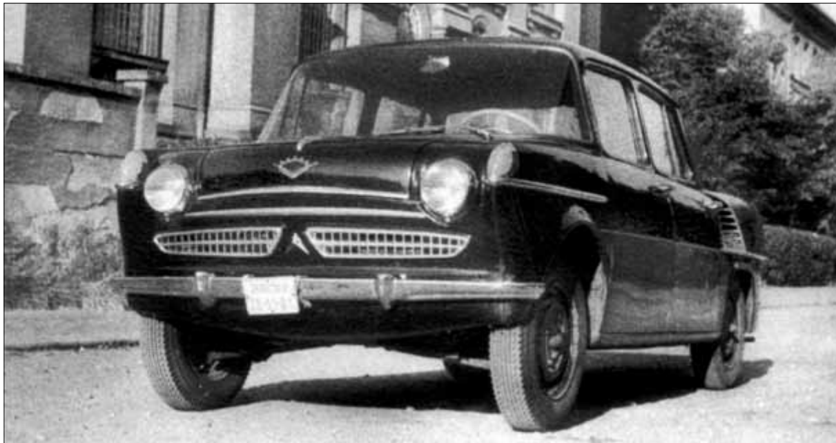
Druhý prototyp Škoda typ 989 měl nejenom mírně upravený design karoserie, ale byl také poháněn novým litrovým čtyřválcem s ventilovým rozvodem OHC.
