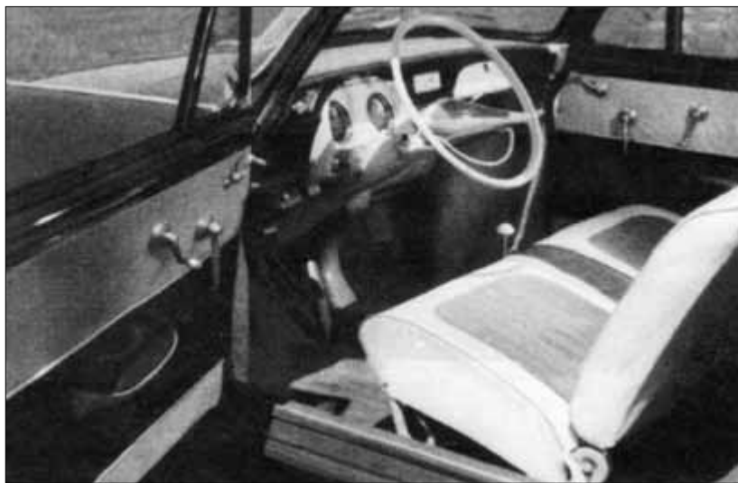
Přístrojová deska prototypových tudorů 990T/990TS svým uspořádáním odpovídala řešení použitému i u dvoumístného roadsteru typu 991
