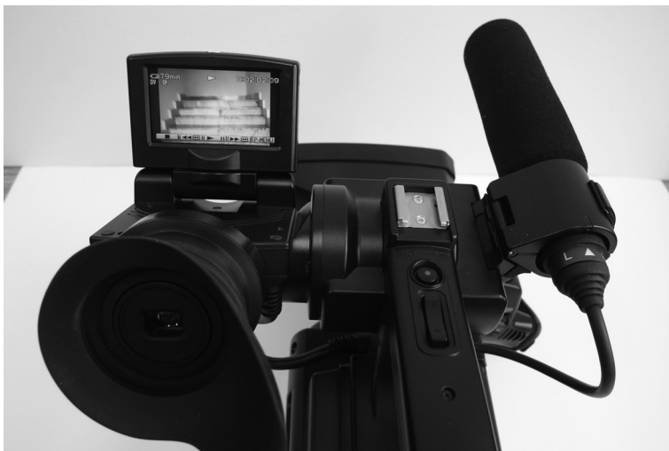
Obrázek 27: Dva typy hledáčků na jedné kameře. Kameraman si může zvolit nevhodnější variantu pro dané natáčení
