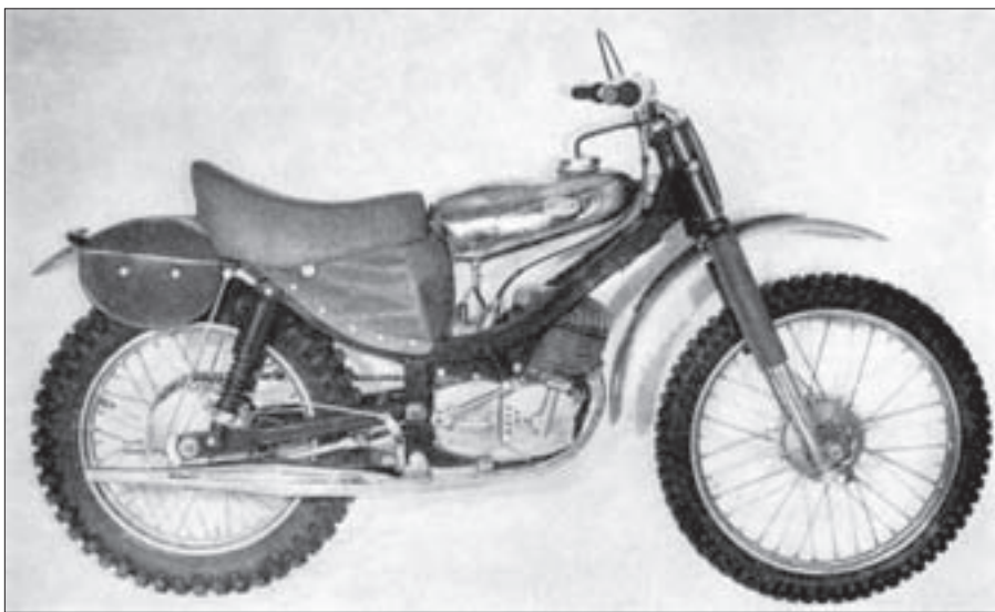
Jawa 250 zcela nové koncepce. Největší novinkou byla rámová konstrukce.
