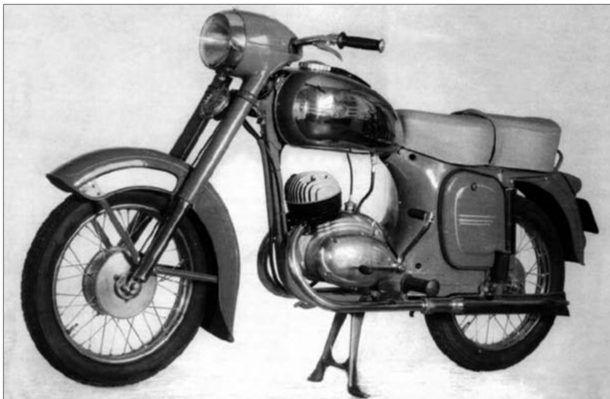
Jawa-ČZ 150 typ 352 po modernizaci – s novým typem brzdových bubnů z roku 1955
