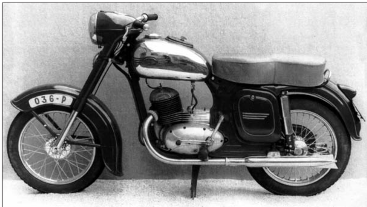
Prototyp modernizované stopětadvacítky Jawa-ČZ 125 typ 355, ještě s původními brzdovými bubny z roku 1955
