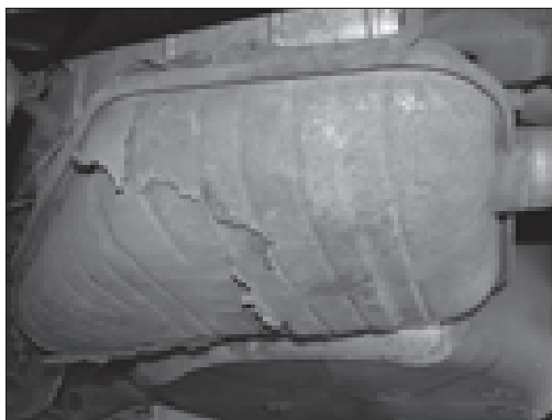
Vnější obal výfuku je zkorodovaný – tlumič ihned vyměňte (ilustrační foto)
