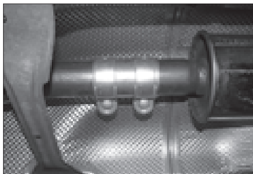
Spoje jednotlivých součástí výfuku musí být spolehlivě upevněny, bez známky koroze a úniku výfukových plynů
