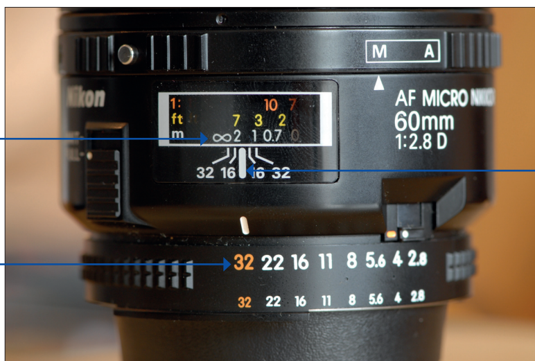
Obrázek B.1 Hloubku ostrosti lze odečíst z objektivu
